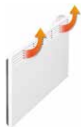
Austrittsöffnung nach vorne verhindert Staubschlieren
