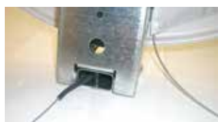
Heizleiter zur Beheizung des Empfangsarms
